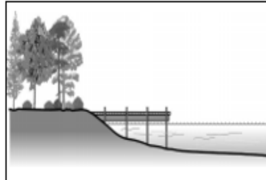
Installation non conforme ne respectant le prolongement linéaire du terrain
