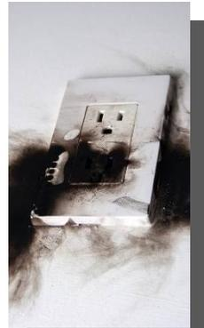
Évitez de surcharger les prises de courant. Utilisez plus d'une prise de courant si la consommation en watts de l'ensemble des lumières dépasse la capacité de la prise de courant.
