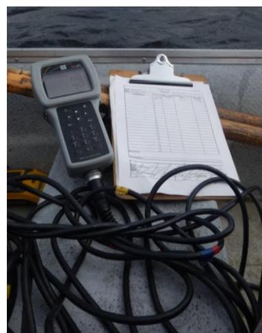
**Figure 2 : Multisonde YSI 556**
